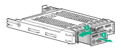
To remove the drive carrier:
