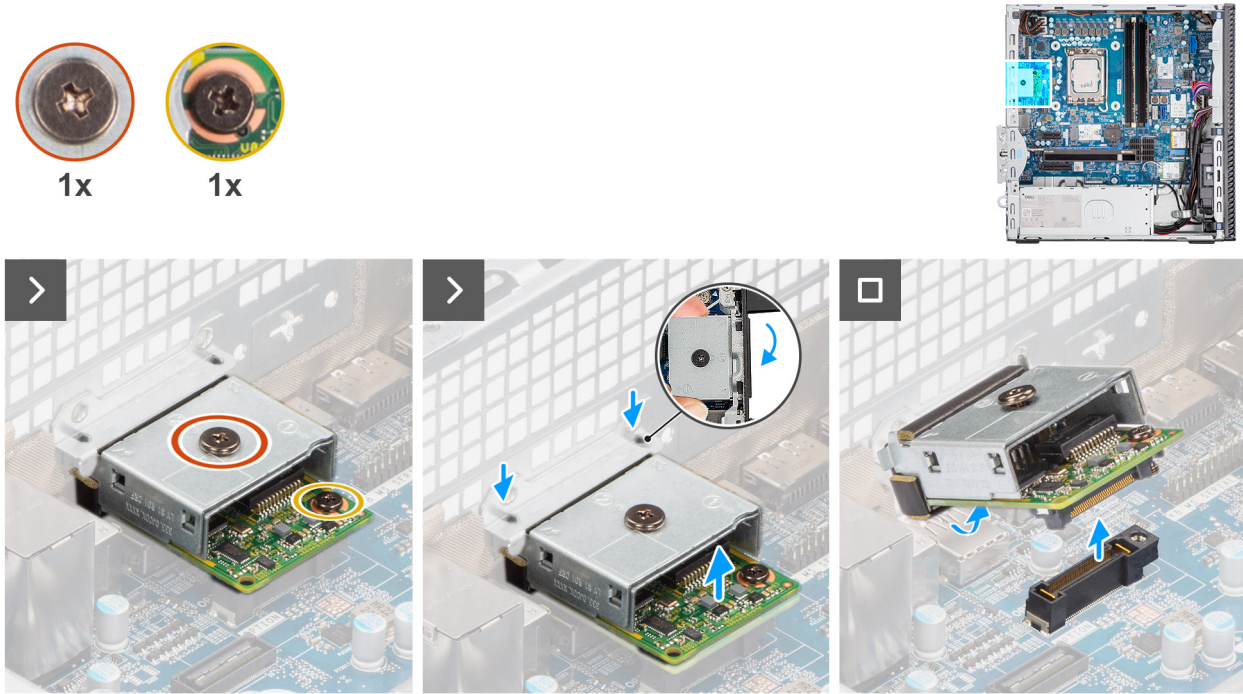
Figure 70. Removing the optional LAN module
